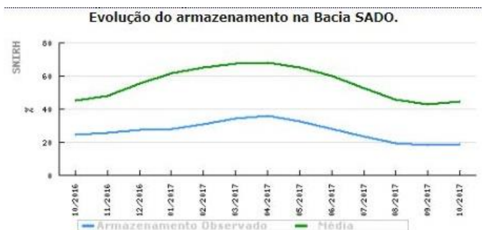
Figura 11 – Evolução dos volumes armazenados na bacia hidrográfica do rio Sado comparativamente à média mensal calculada para o período (1990/91 a 2015/16) (Fonte: APA).
