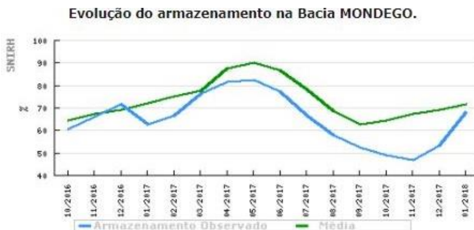
Figura 8 – Evolução dos volumes armazenados na bacia hidrográfica do Mondego comparativamente à média mensal calculada para o período (1990/91 a 2016/17) (Fonte: APA).
